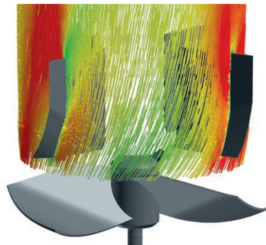
Подробная схема характера движения потока с импеллером ЕКАТО TORUSJET
